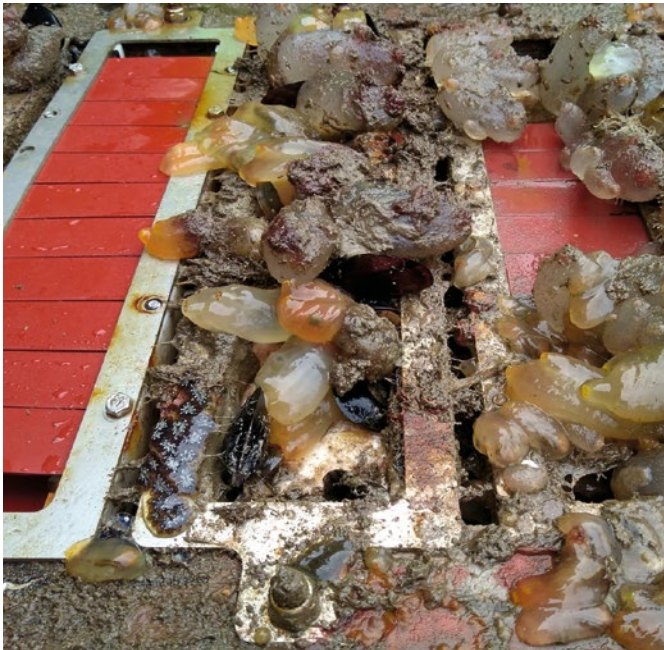
Beschichtungsproben mit verschiedenem Bewuchsgrad
