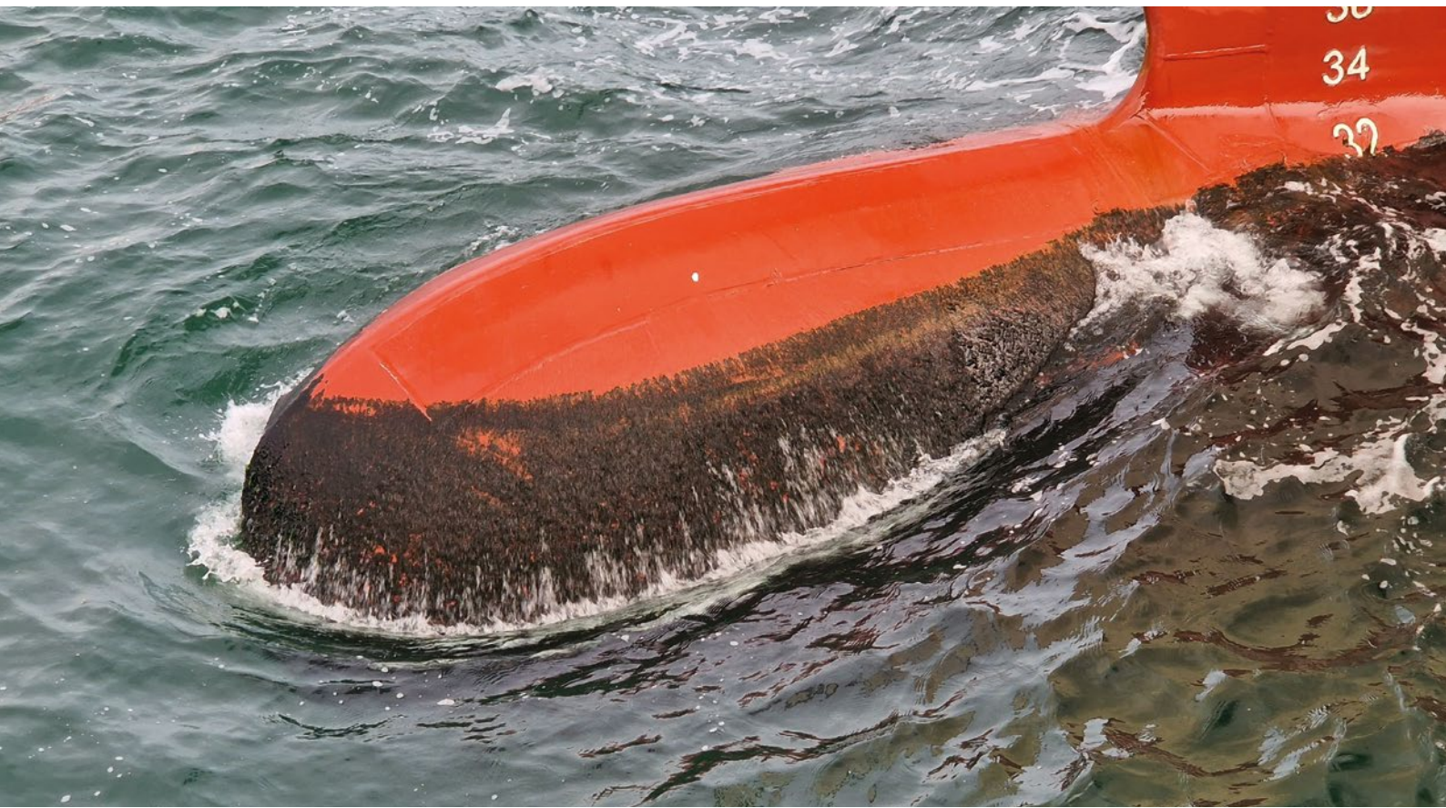
Schiffsbug mit Bewuchs im Unterwasserbereich
